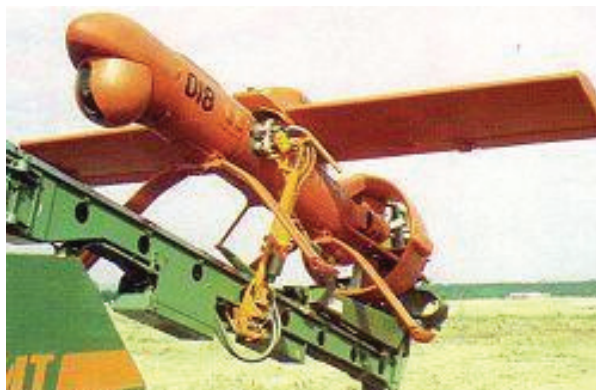
Разведывательный БПЛА «изделие 61 «Пчела» ОКБ Яковлева, 1990 год
